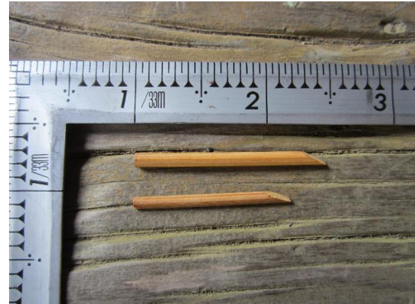
これが「竹釘」・・・竹で作った釘。 これで檜皮を屋根に固定するのです。
