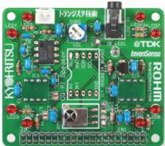
図5 AIスピーカー製作用プリント基板
