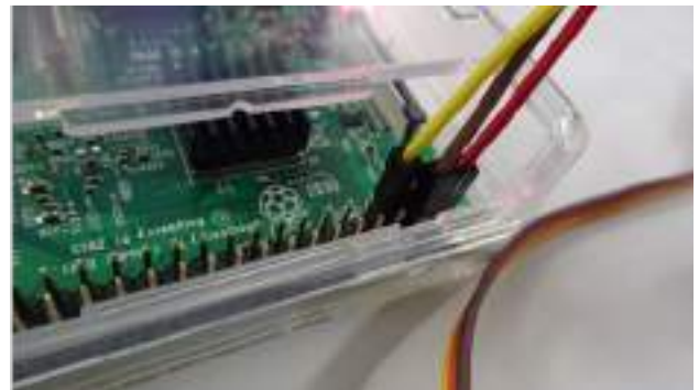
図4 Raspberry Pi の GPIO に接続した様子 (3) SQLite について
