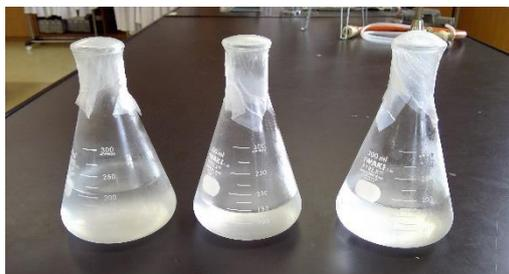
図13 減圧蒸留によって取り出した液体
