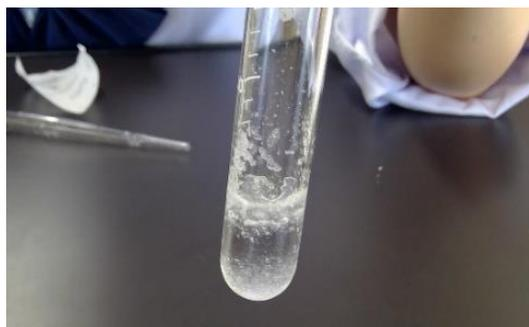
図10 SiO<sub>2</sub> で水を吸収している様子
