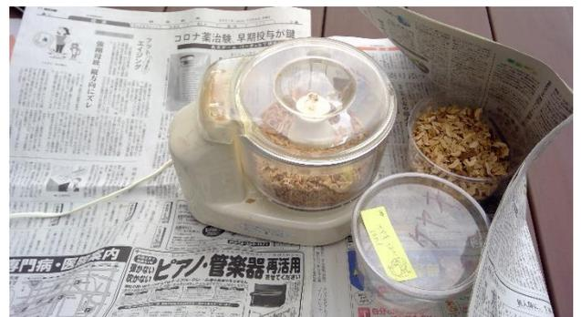
写真 3, ケヤキのウッドチップを食用ミキサーで細かくする様子
