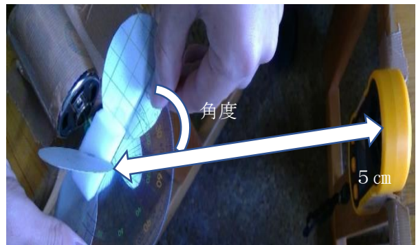
図7 実験2の風速測定法
