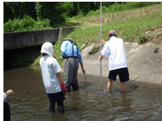
石を川に積む前に流速や水深を測ります。
