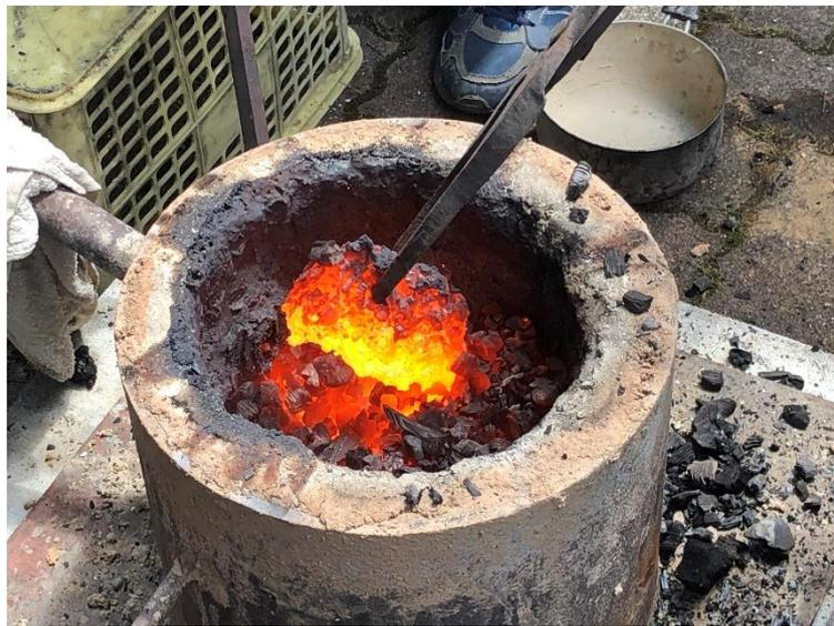
卸し鉄実験の様子。溶解した鉄塊を平箒で炉底から取り出す。
