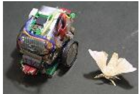
昆虫脳をモデルとしたロボット (東大・神崎・高橋研究室 HP より)
