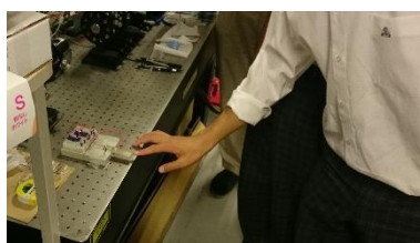
圧電フィルムを押しして発電
