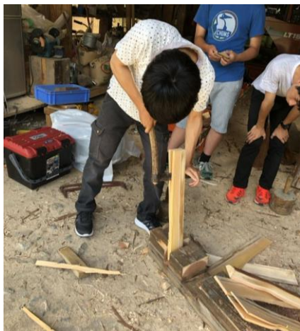
写真1 樽板（屋根板）の製作
