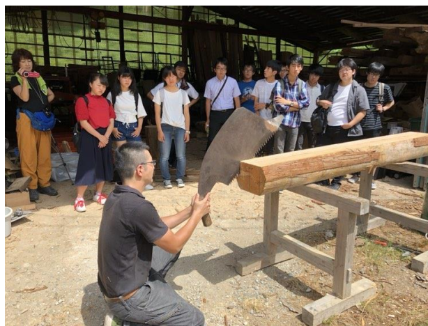
写真2 大鋸（近世以降に普及）の実演 ※ともに荒木昌平氏の工房（飛騨市）
