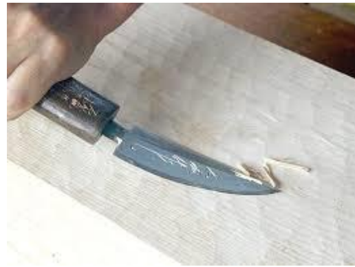
写真 20 ヤリガンナの使用例
