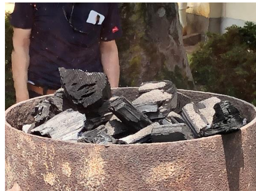
4段に積んだ簡易炉一杯に木炭を詰める
