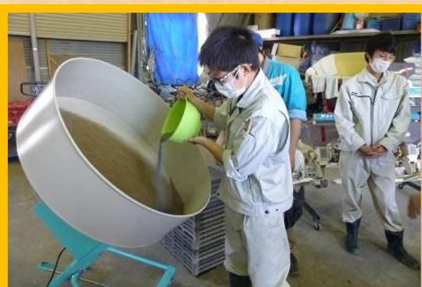
鉄粉と焼石膏を加え、攪拌する。
