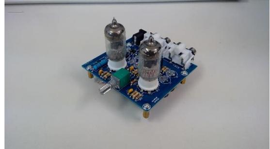
図1 6j1真空管プリアンプ外観
