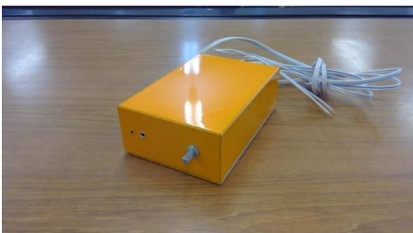
図4 完成したパワーアンプ
