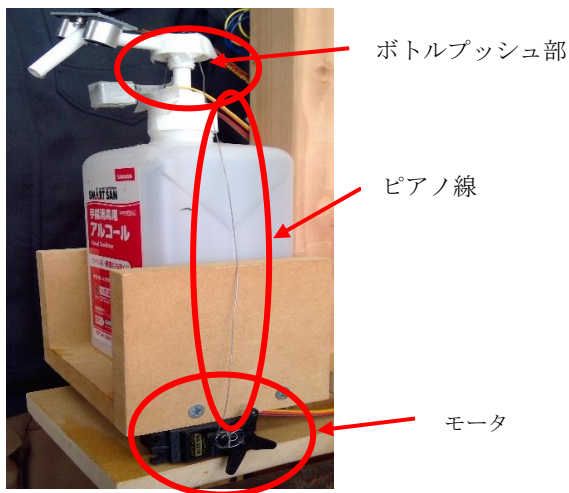
図4 ディスペンサの構造
