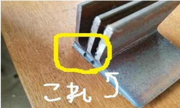
切断時にバリ(材料を加工した時に出る突起物)がでた。
