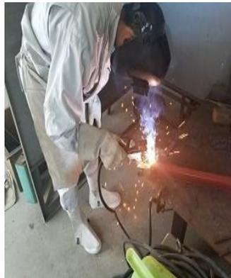
溶接がプロ並みに上達したところで、実際の作品の製作作業を行った。作業するなかで熱による変形や、穴があかないように溶接した。
