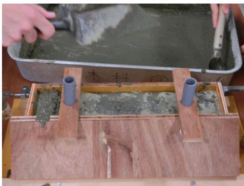
コンクリート打ち込みの様子
