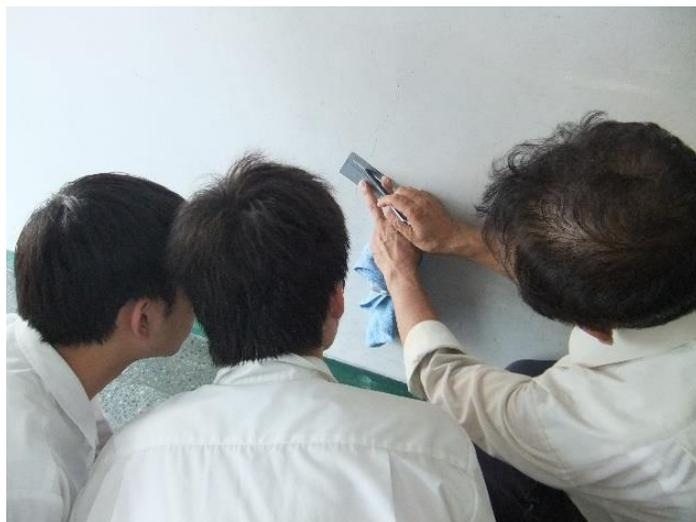
写真：壁に生じているひび割れの大きさを、クラックスケールで読み取る生徒たち
