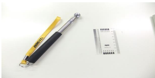
写真3 左：打診棒 右：クラックスケール
