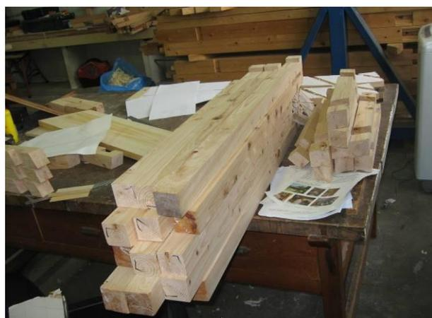
羽板と輪板の墨付けは、一つひとつ墨付けを行うのではなく、CADで製作した図面を水のりで貼り付け、そのまま加工することにした。その他の部材は、通常通り鉛筆やボールペンと、さし金使って墨付けをしていきました。
