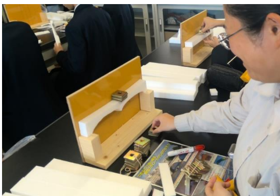
作成した橋に重りをのせ、耐荷重を確認
