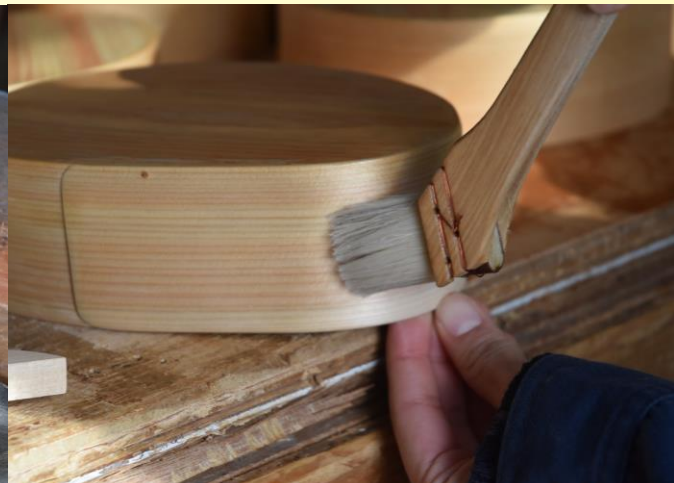
刷毛で塗装を行っているところ
