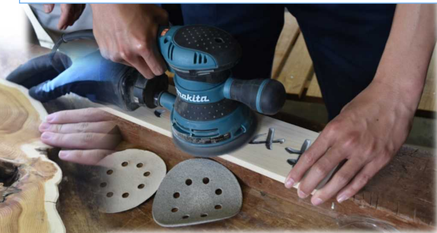
NC班・看板の研磨作業
