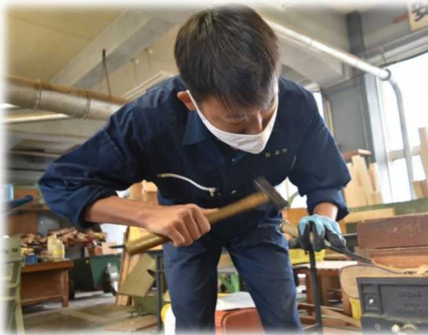
手のみを用いて竹を加工
