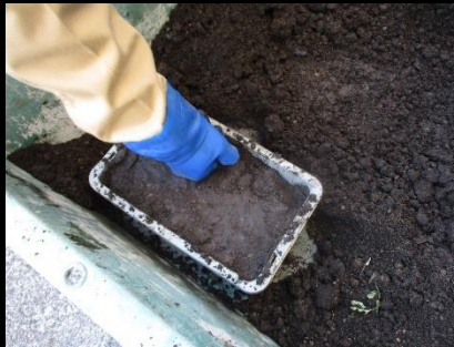
①畑の土を使用し水を含ませる ②型に押し固める ③型から出して乾燥させる
