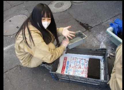
①畑の土を使用し水を含ませる ②型に押し固める ③型から出して乾燥させる
