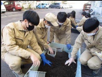
①畑の土を使用し水を含ませる ②型に押し固める ③型から出して乾燥させる
