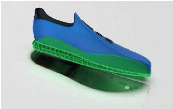
Fig.3 製作したシューズのモデル(断面)
