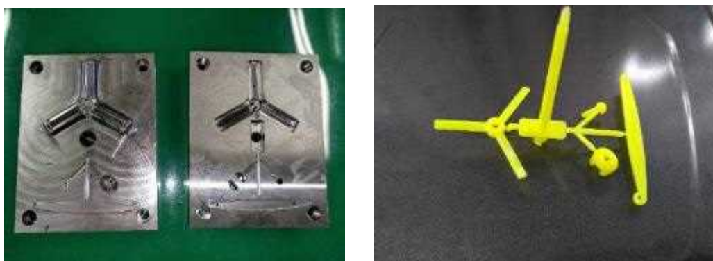
Fig. 4 加工した金型入れ子と射出成型品 協力：(株)岐阜多田精機 様
