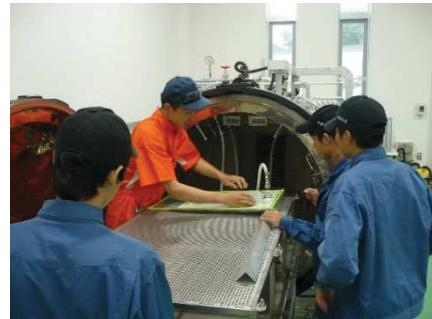
Fig. 14 オートクレーブによる成形
