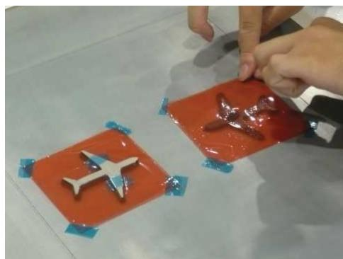
Fig. 15 飛行機型のCFRP製キーholderー
