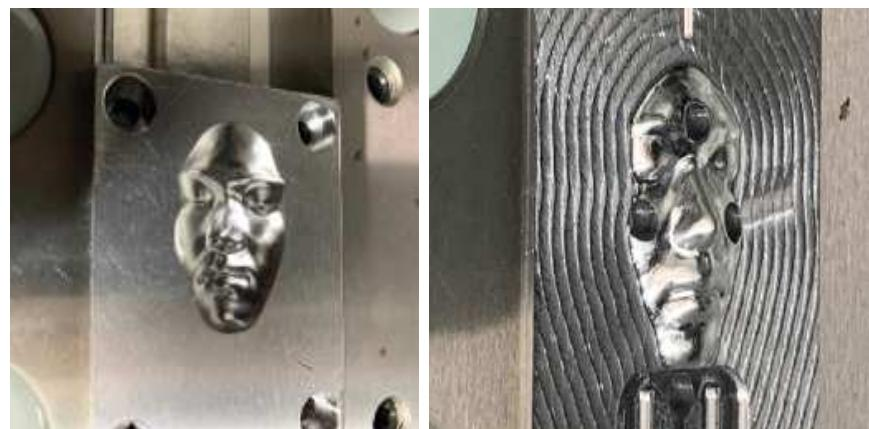
Fig. 6 入れ子(cavity & core)の加工品
