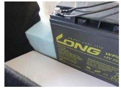
Fig. 13 プラ版によるバッテリー固定
