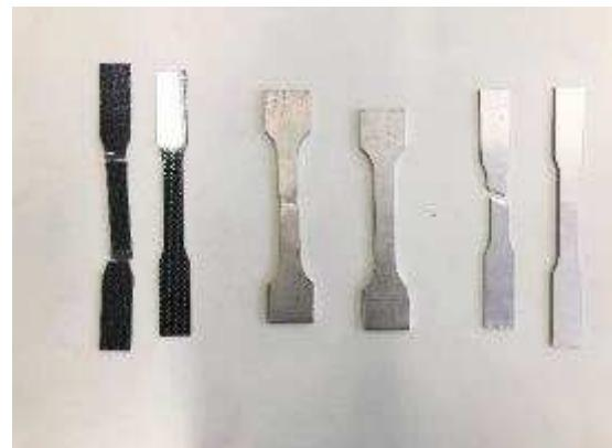
Fig. 24 試験片 (左：引張試験後 右：試験前)
