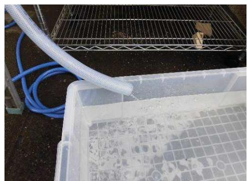
Fig. 11 完成した汎過装置と濾過実験の様子
