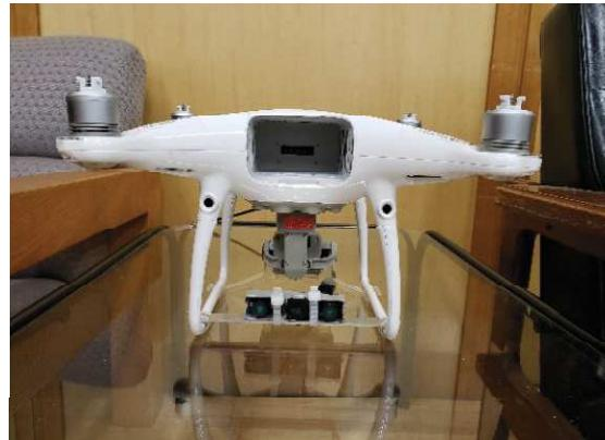
Fig. 13 3Dカメラ搭載ドローン
