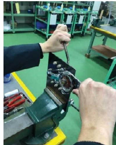
Fig.18 トルクレンチでの締結
