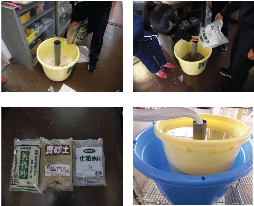
Fig. 9 砂沪過槽製作の様子
