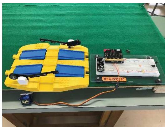
Fig. 19 サーボモータによる踏切制御
