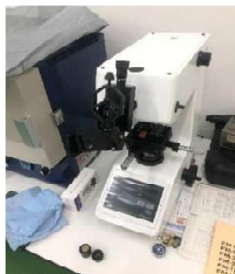
Fig. 26 ビックカース硬さ試験機
