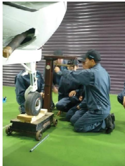
Fig. 21 秤での測定
