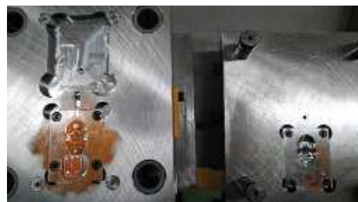
Fig. 8 可動型固定型のアタリ具合の確認
