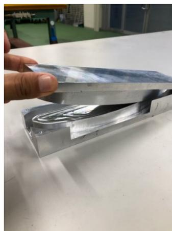
Fig12 治具との干渉具合の確認
