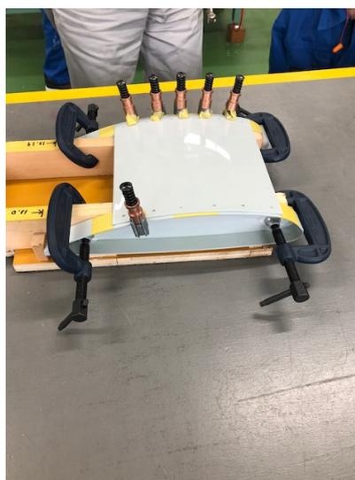
Fig22 治具に取り付けた各部品
