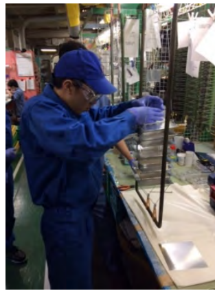
Fig27、Fig28 表面処理のため金具に取り付け、
