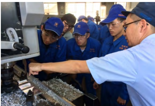
Fig23 汎用フライスで切削加工している様子
