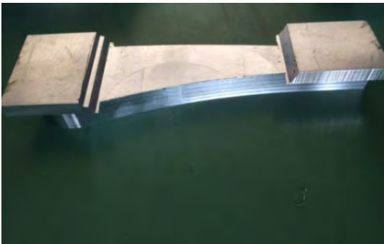
Fig22 裏面的一部分を汎用フライスで切削加工
