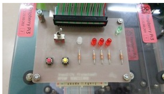
Fig22 設計した I/O 回路
