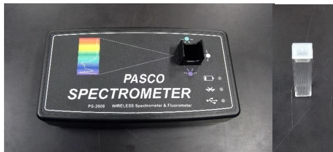
図1 ワイヤレス分光センサとセル
