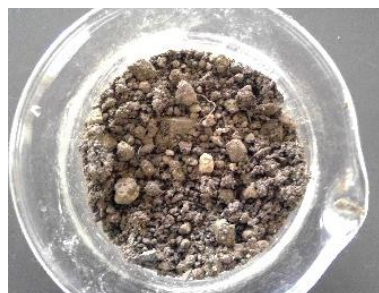
図4 実験4 40mLの団粒構造の様子
