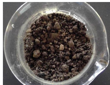
図5 実験4 60mLの団粒構造の様子
