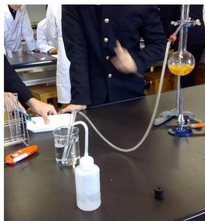
図2 蒸留の装置
