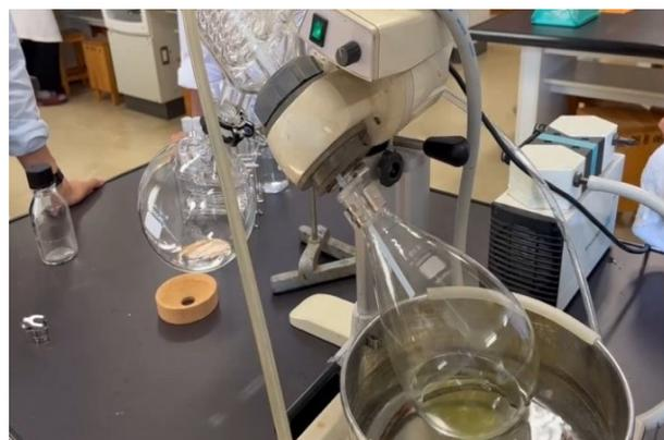
図 4 エバポレーターによるヘキサン除去
