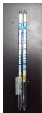
図14 音なし(左)2000Hz(右)の検知管比較
