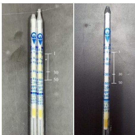
図12 音なし(左)測定前(右)の検知管比較と2000Hz 検知管
