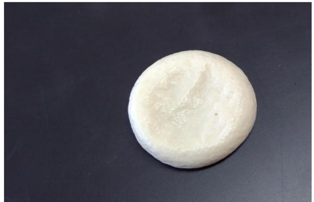
図 実験(4)の 50℃での牛乳プラスチック
