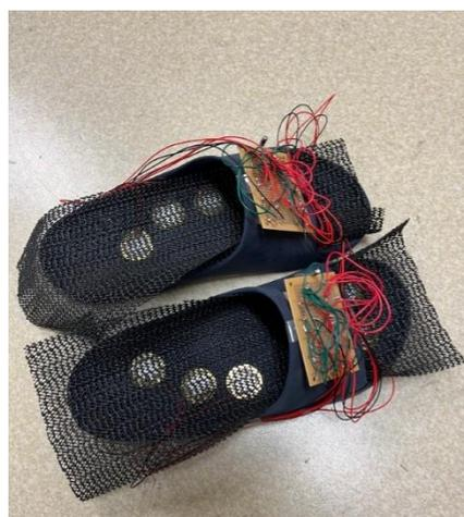
図 4 発電機を取り付けたスリッパ
