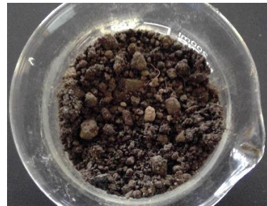
図 5 実験 4 の 60mL の団粒構造の様子
