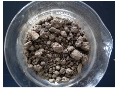
図 3 実験 4 の 0mL の団粒構造の様子
