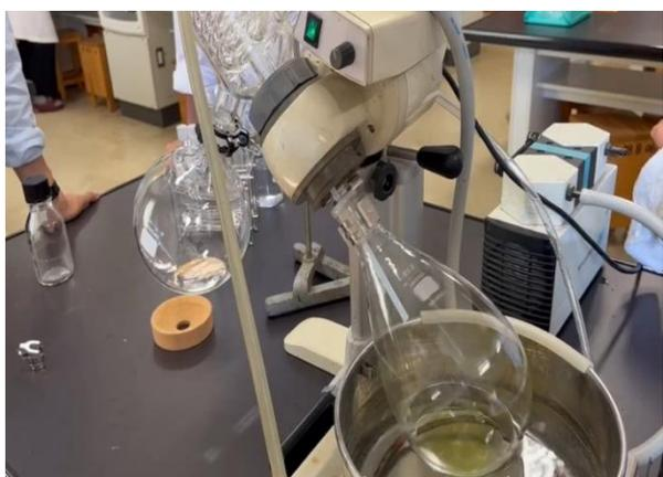
図4 エバポレーターによるヘキサンの除去
