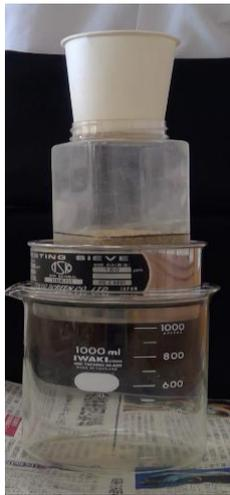
図3 実験1におけるクレイ舗装モデル
