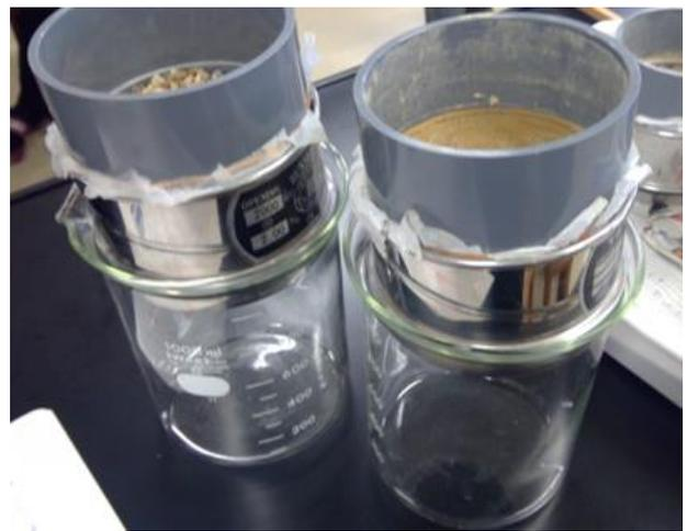
図4 実験2におけるクレイ舗装モデル
