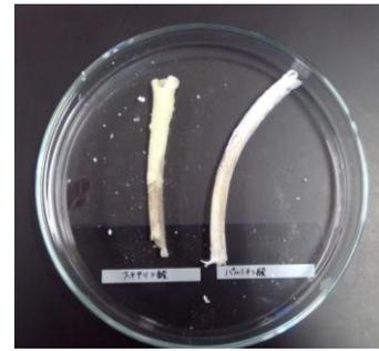
図4 飽和脂肪酸によるコーティングを施した寒天ストロー
