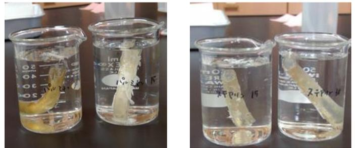
図5 飽和脂肪酸コーティングが剥がれ、膨張する寒天ストロー
