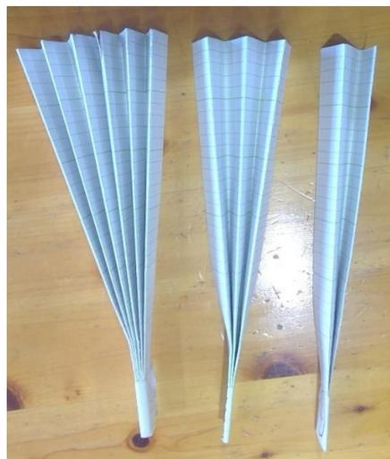
図 3 実験に使用したハリセン (左：11 回折り、中央：5 回折り、右：2 回折り)
