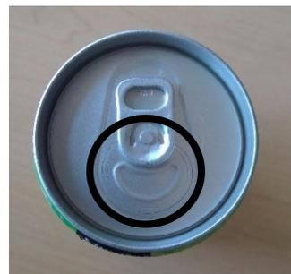
図4. スコア(上図赤丸内部の部分)
