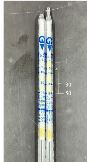
図 14 音なし(左)測定前(右)の検知管比較
