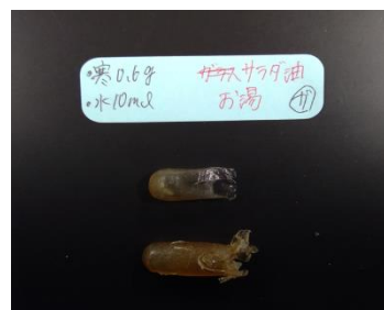
図3 射出成型法 成功例①
