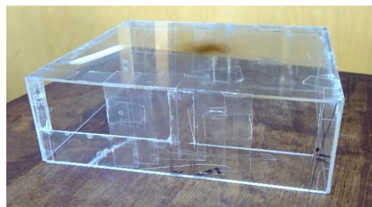
図2 実験装置(アクリルで作成した教室モデル)
