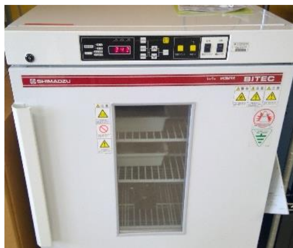
図12 インキュベーターを用いた発電装置の温度管理の様子
