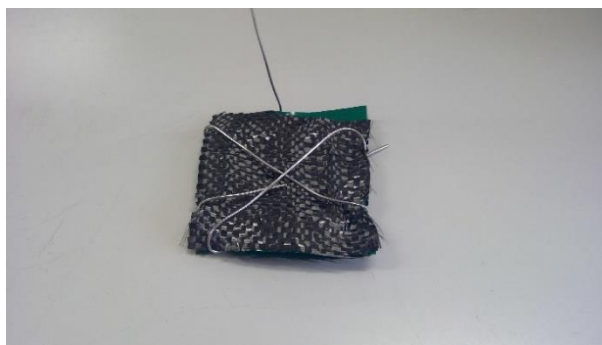
図7 作成した電極2（ニッケル線を使用）
