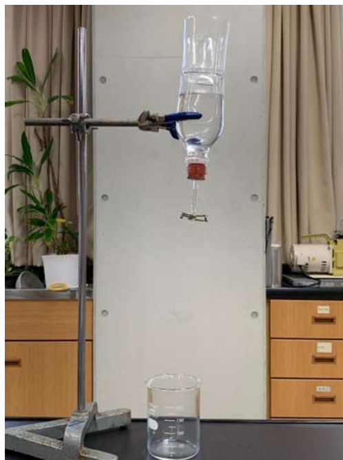
写真2 温度による音の違いの検証のための装置
