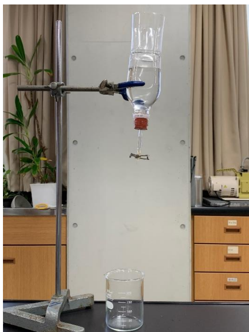
写真 1 温度による音の違いの検証のための装置
