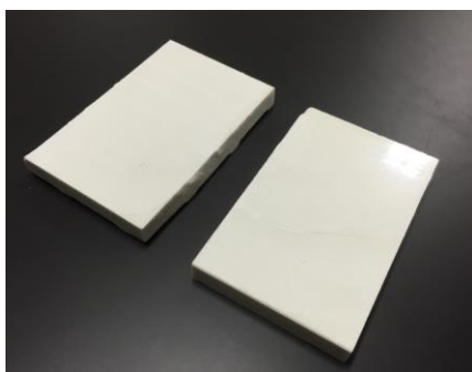
図 3 作成した酸化チタンタイル
