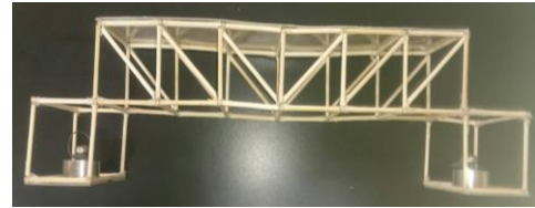
図6 ワーレントラスの模型
