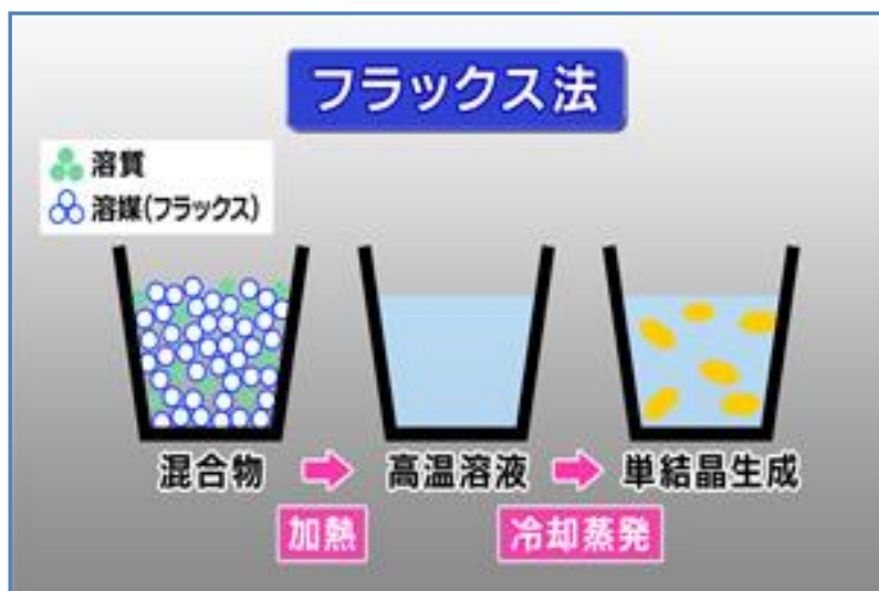
図1 フラックス法の原理
