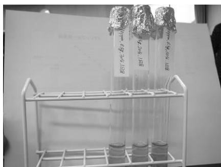
(写真Ⅲ：左から順に 10 分、20 分、30 分メチレンブルーを照射したもの)
